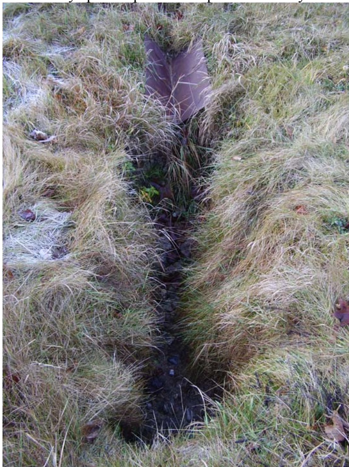
Thomsonův měrný splávek pro měření průtoků drobných toků
