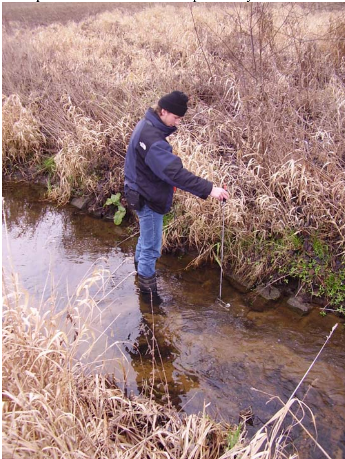
Thomsonův měrný splávek pro měření průtoků drobných toků
